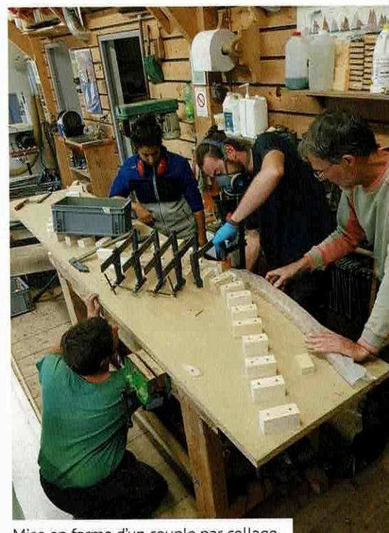
Mise en forme d'un couple par collage, en lamellé-collé de lattes d'Iroko.
